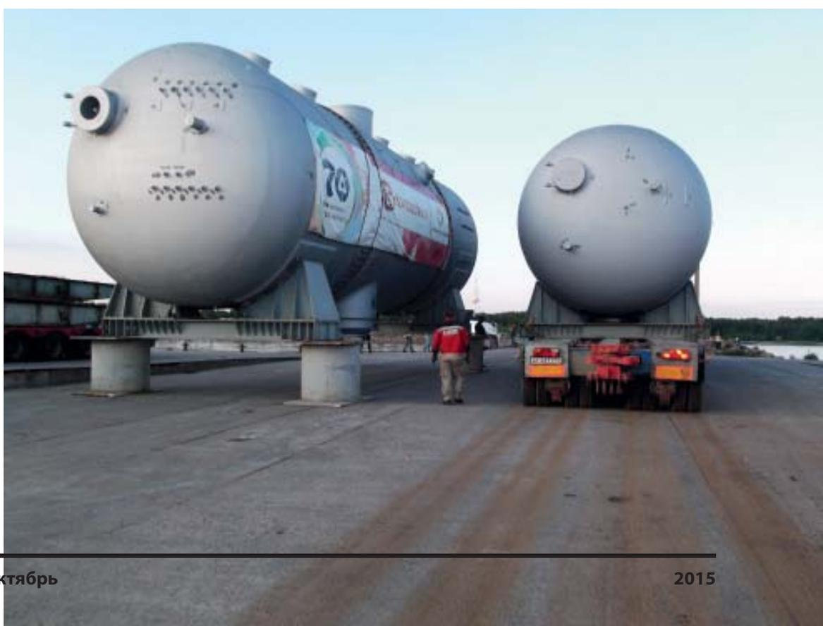
станции «Серпухов» парогенераторы были перегружены с помощью портальной системы компании «СВ Транс» (грузоподъемностью 600 тонн) на модульные прицепы.
