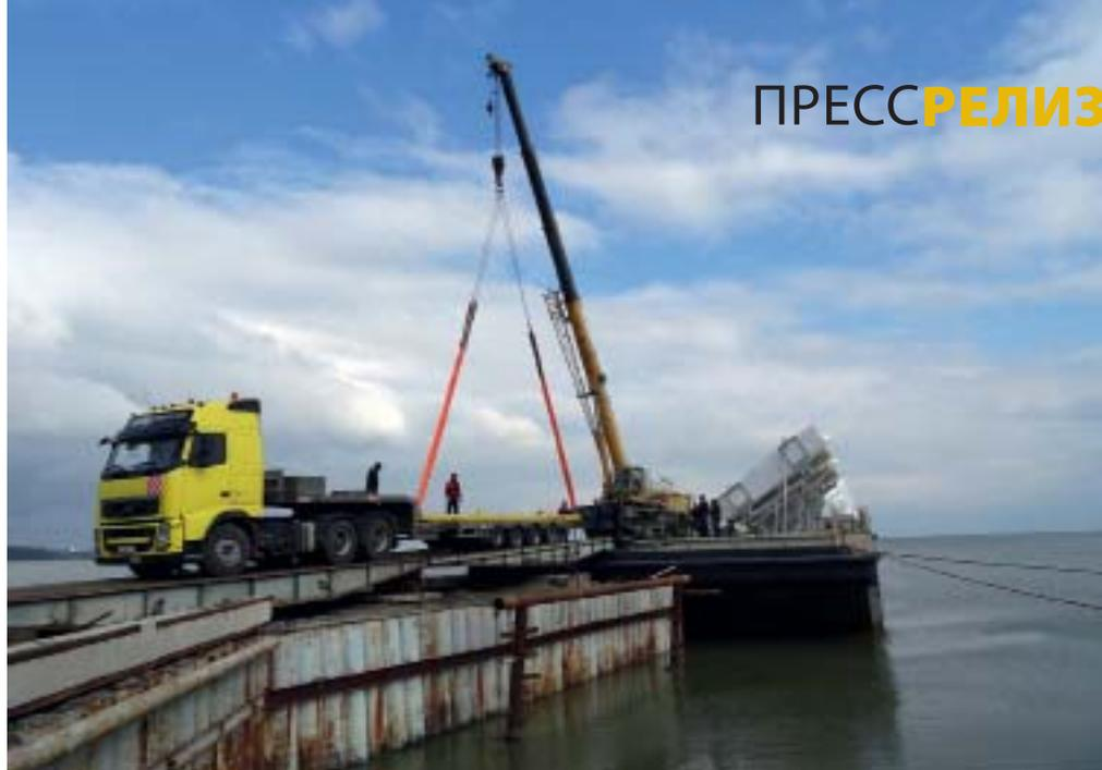
нерами ООО «СВ Транс» было принято решение перегрузить два фюзеляжа на самоходные модульные прицепы (СПМТ) Scheuerle и за счет гидравлики SPMT преодолеть высокий подъем, тем самым обеспечивая сохранность негабаритных грузов. Выполнив выгрузку с баржи методом РО-РО, сотрудники «СВ Транс» приступили к перегрузке с одного прицепа на другой с применением гидравлики осей.
