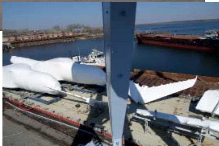
После подачи баржи ожидавшие на причале машины с негабаритными грузами поочередно были перегружены на баржу, согласно схеме размещения частей самолетов на судне. Первыми выполнили погрузку методом РО-РО двух фюзеляжей на специ-
