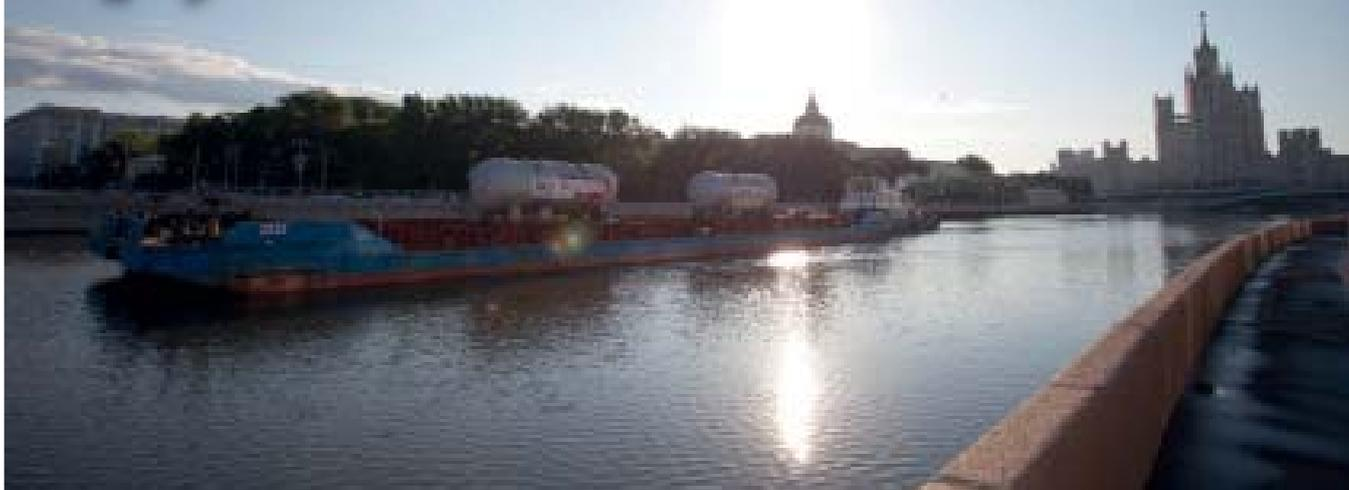
**Первая партия парогенераторов для второго энергоблока доставлена на Ленинградскую АЭС-2 по интермодальной схеме - железнодорожным, речным и автомобильным транспортом. Четыре парогенератора весом 390 тонн каждый, длиной 13,5 м и 4,5 м в диаметре были доставлены на 2-й энергоблок компанией «СВ Транс».**
