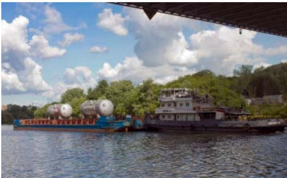
Погрузка парогенераторов на баржу-площадку была произведена методом RO-RO, заключающимся в закатке оборудования на транспортном полуприцепе через судовые аппарели. На одну баржу было погружено два парогенератора. Далее по реке негабаритное оборудование отправилось в г. Сосновый Бор, Ленинградской области.
