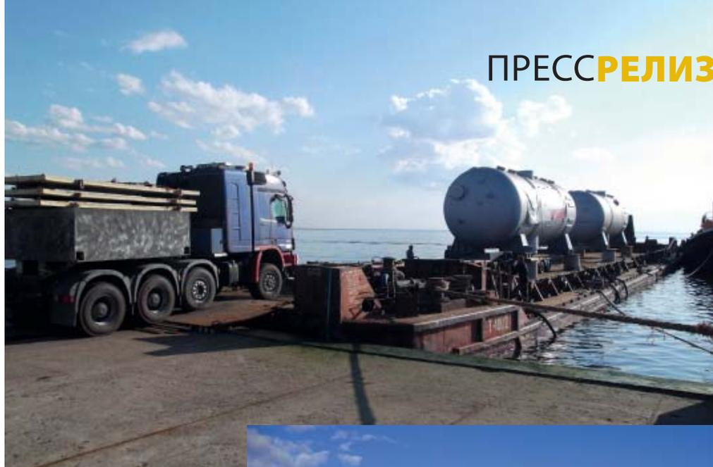
по железной дороге. Для перевозки тяжеловесного негабаритного оборудования на автотранспорте сварщики изготовили по проекту инженеров специальные ложементы под данные парогенераторы. После отсоединения всех частей заводских ложементов парогенератор был погружен на автотранспорт компании «СВ Транс». Таким же образом были перегружены все четыре парогенератора из данной партии, направляющиеся на ЛАЭС-2.
