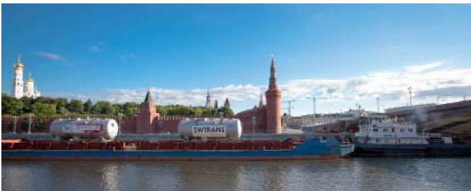
АЭС-2. Погрузка парогенераторов на баржу-площадку была произведена методом RO-RO, заключающимся в закатке оборудования на транспортном полуприцепе через судовые аппарели.
