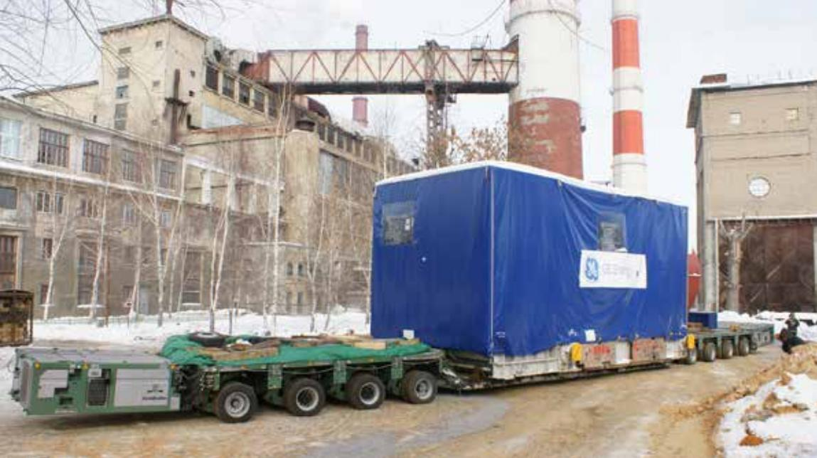
жет точно управлять поворотом колес полуприцепа независимо от поворотов тягача. Автопоезд, таким образом, может описывать сложные траектории.
