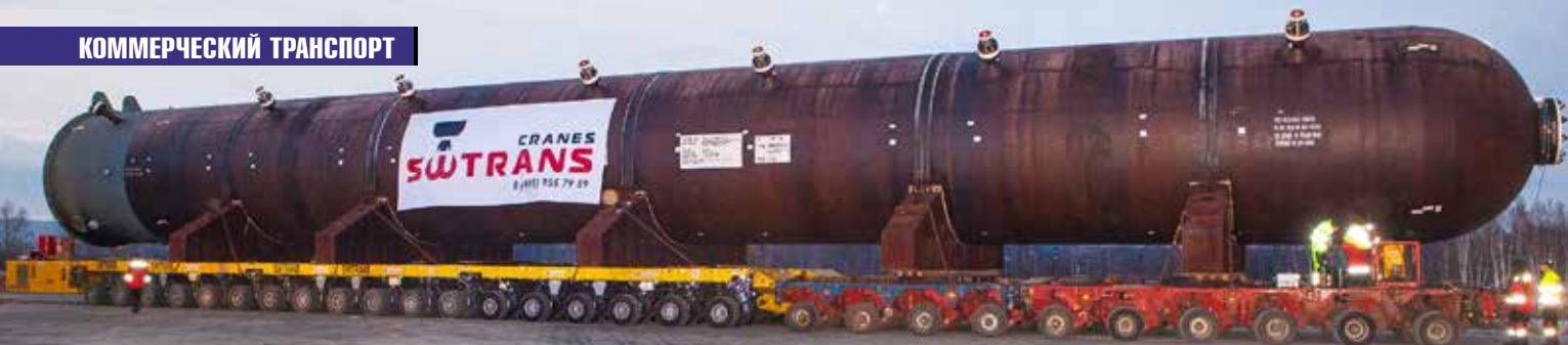
Перевозка колонны на прицепе Scheuerle в комбинированной сборке SPMT и InterCombi
