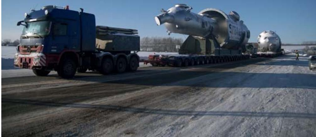
Для транспортировки оборудования в количестве пяти негабаритных позиций с комплектующими общим весом 783,250 тонн, инженерной группой «СВ Транс» была разработана мультимодальная схема перевозки, включающая несколько видов транспорта и перегрузку в процессе доставки крупногабаритных тяжеловесных грузов.
