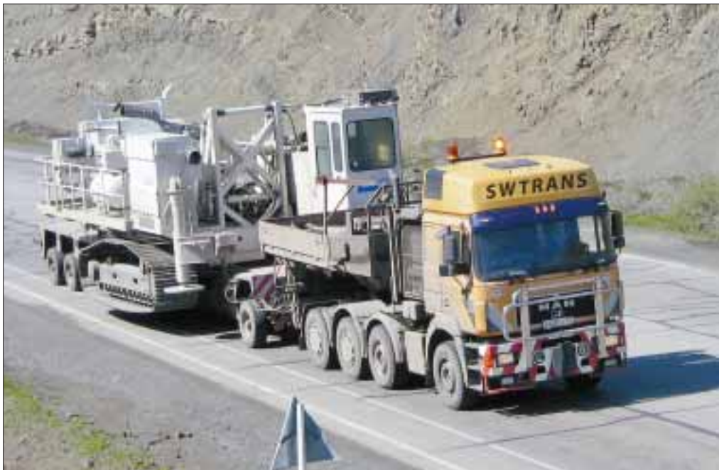
ПЕРЕВОЗКА БУРОВОЙ УСТАНОВКИ: НЕСУЩИЕ БАЛКИ ПРИЦЕПА ПОДДЕРЖИВАЮТ ЕЕ ПОД ДНИЩЕ
