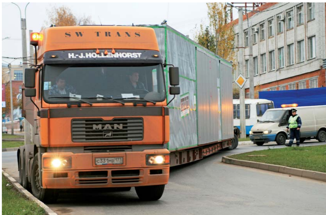
Чтобы вписаться в некоторые повороты, водителю негабаритного автопоезда приходится использовать всю ширину проезжей части в буквальном смысле слова до сантиметра
